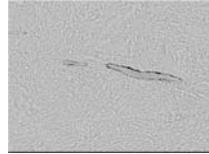
MnS incelemesi ve ısıt işlem mikroyapısı
