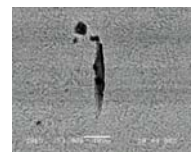
Çelik malzemede inklüzyon incelemesi
