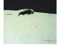
Alüminyumda yüzey kabarcığı incelemesi
